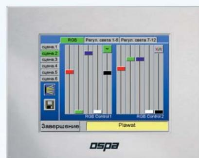
Управление освещением. В системе можно запрограммировать 6 различных световых сценариев (2 канала RGB, 12 диммерных каналов)
